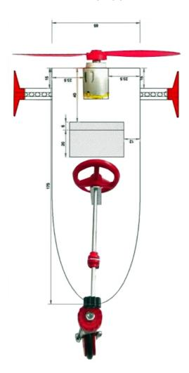
B) Postez le dernier trou d'arbre Ø3x120mm de la bande perforée de chaque côté. Ensuite, nous insérons les deux roues directrices, qui servent de roues. Ces roues de profil si peu ont l'avantage qui causent peu de friction.
