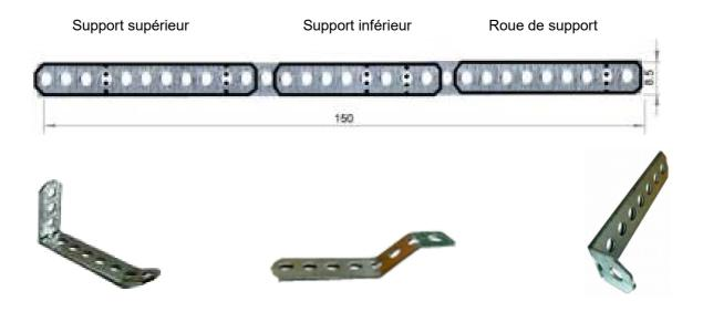
D) Bande perforée roue avant 100mm = Support: Pour soutenir bend en forme de pont doit soigneusement afin qu'il soit exactement le même des deux côtés. Signalisation suivent exactement à la distance entre les deux barres verticales est de 12 mm. La roue doit tourner sans frotter nulle part.
